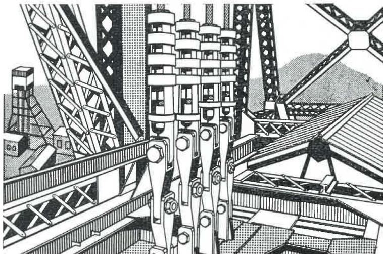
L'extraction par machine à tambour à friction Multicâble peut exiger de faire la patte des câbles dans des endroits parfois grisouteux.
