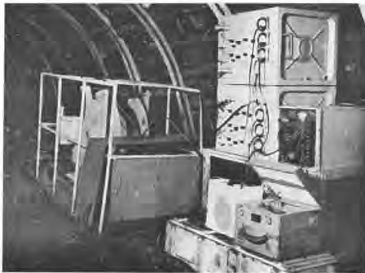
Fig. 6. — Station complète d'enregistrement, y compris le treuil d'enroulement du câble de liaison.
