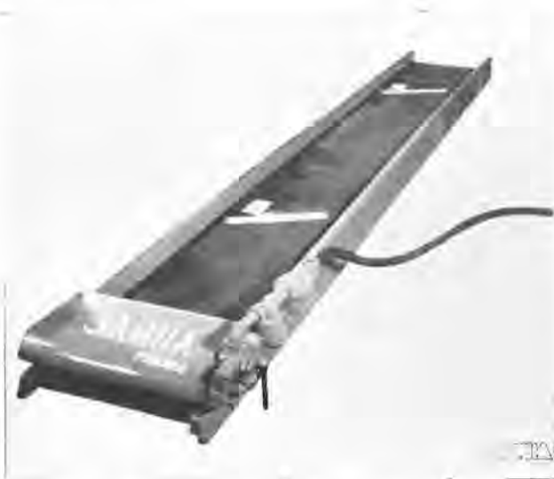
Fig. 3. — Petit convoyeur de 2 m de longueur à bande glissante, facilement transportable.
