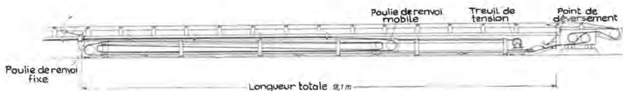
Fig. 32. — Tête motrice du convoyeur extensible mis au point par les ingénieurs du Groupe de Bruay, avec possibilité d'allongement maximum de la courroie de 56 m.
