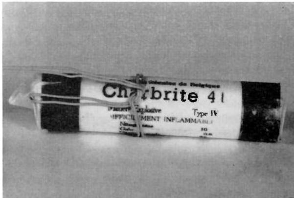
Fig. 41. — Cartouche-amorce prête à être placée dans le fourneau.
