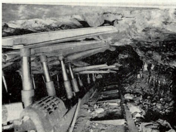
Fig. 30. — Soutènement marchant dans un dérangement de 80 cm.
