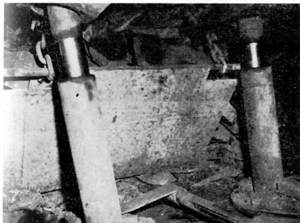
Fig. 28. — Tôle de retenue pour les éboulis de foudroyage.
