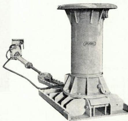
Fig. 7. — Pile hydraulique Desford-Wild de 100 t avec vérin de ripage et crémaillère de liaison.
