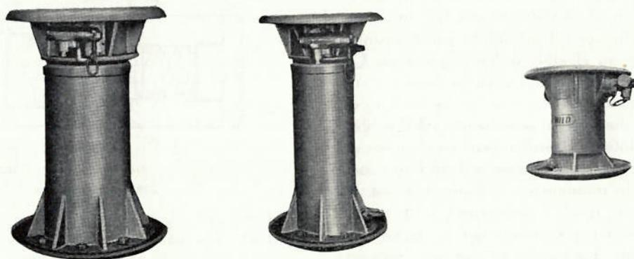
Fig. 1. — Piles hydrauliques Desford-Wild.
