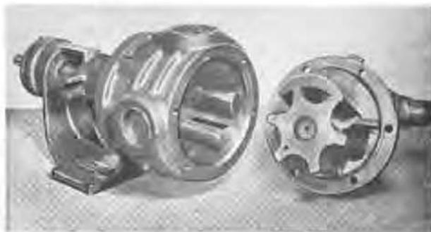
Fig. 9. — Disposition des engrenages à l'intérieur de la pompe Wayne.
