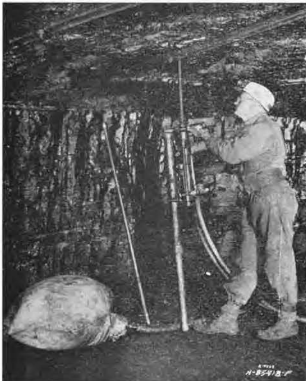
Marteau télescopique VACUJET avec dépoussiérage pneumatique par aspiration.
