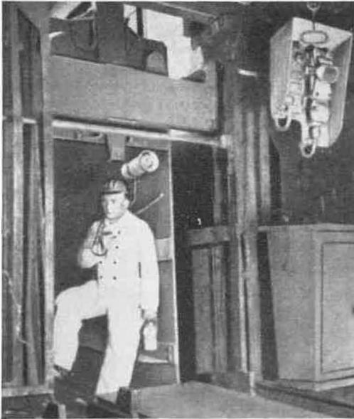
Fig. 5. — Disposition de l'appareillage de téléphonie dans la cage (Installation Standard Elektrik).
