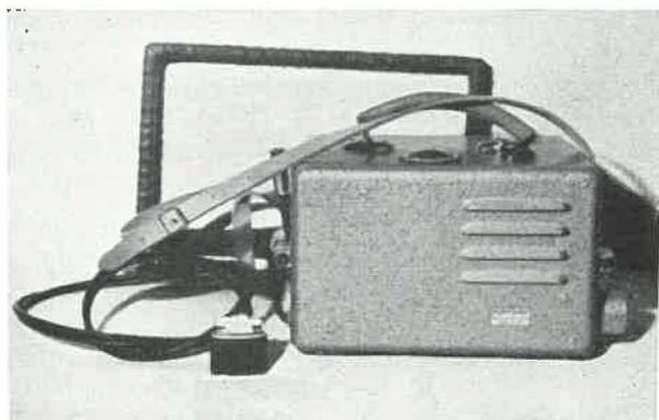
Fig. 7bis. — Poste émetteur récepteur à couplage inductif de la Firme May Day.
