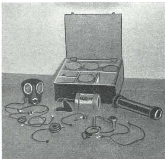
Fig. 13. — Coffret contenant le téléphone et l'appareillage pour liaison entre une équipe de reconnaissance en zone sinistrée et la base de départ.
