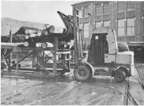
Fig. 7. — Alimentation des estacades de chargement des bois non façonnés.
