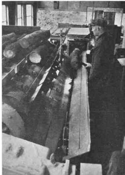
Fig. 9. — Alimentation de la scie à façonner les bèles (scie circulaire).
