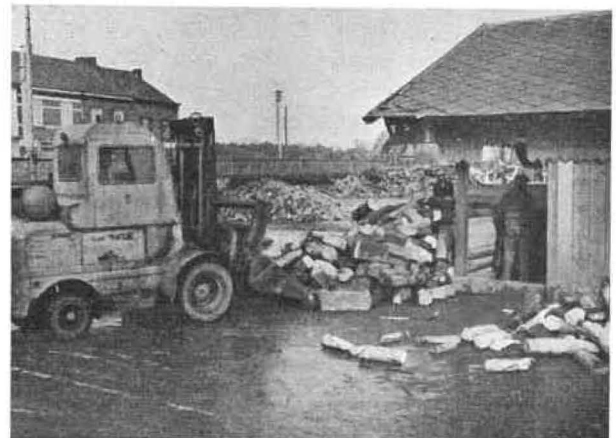
Fig. 21. — Reprise des déchets de bois par auto-levieur.
