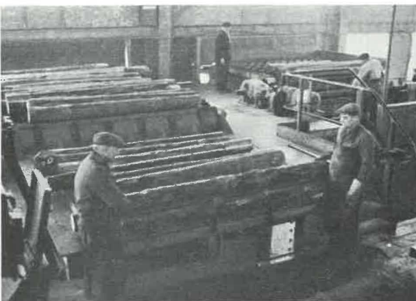
Fig. 16. — Alimentation des machines de façonnage des pointes et des tins.
