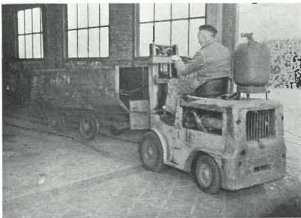
Fig. 14. — Mise en place des wagonnets par auto-leveur.
