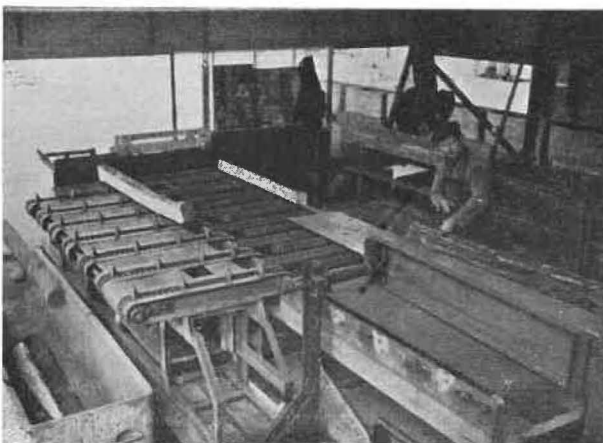
Fig. 10. — Chargement automatique des bèles en wagonnets.
