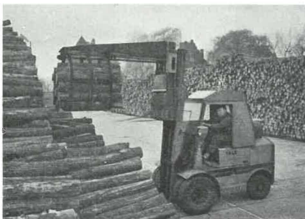
Fig. 3. — Mise en tas des bois par auto-levieur.
