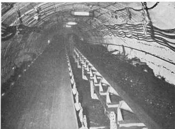
Fig. 20. — Station de culbutage : transporteurs inclinés reliant la trémie sous les culbuteurs aux cribles placés en tête du burquin.
