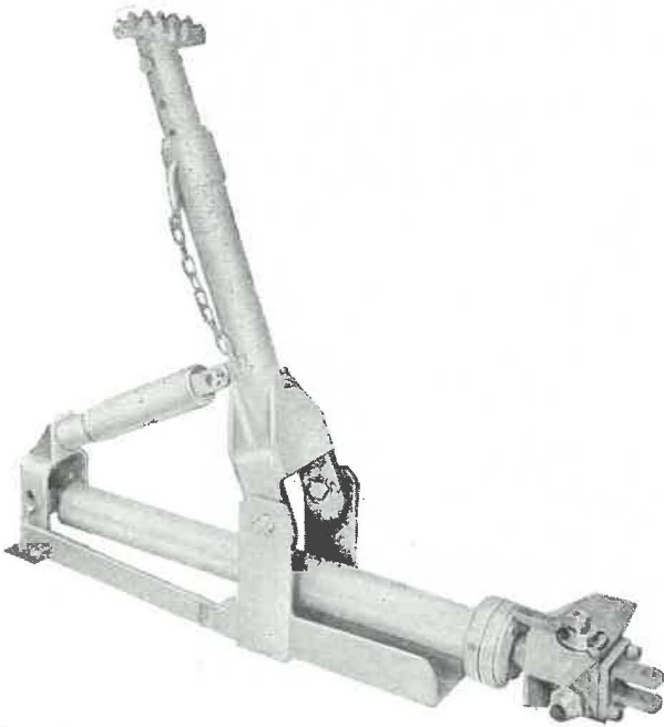
Fig. 28. — Pousseur hydraulique Gullick pour convoyeur blindé.
