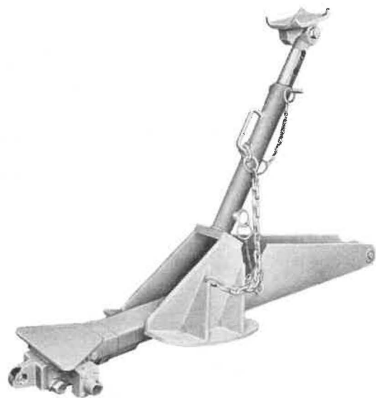
Fig. 27. — Pousseur hydraulique Dowty pour convoyeur blindé.
