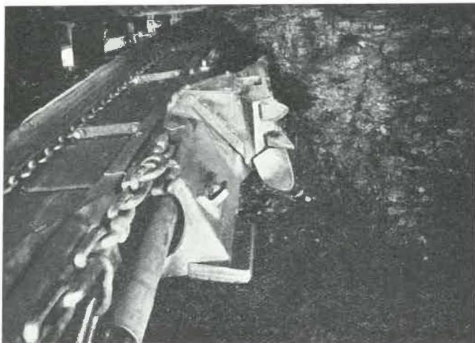
Fig. 8. — Photographie du rabot en couche « Veinette ».
