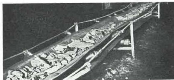
Fig. 14. — Convoyeur à courroie avec infrastructure à câbles métalliques.
