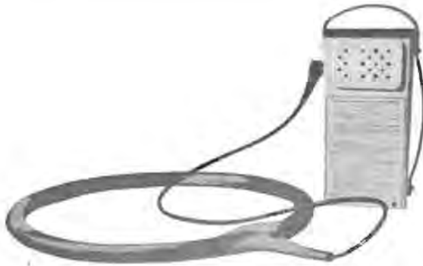
Fig. 26. — Poste émetteur-récepteur de sécurité intrinsèque, Demélon.
