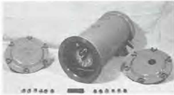
Fig. 35. — Camera dans un coffret anti-déflagrant avec ses couvercles.
