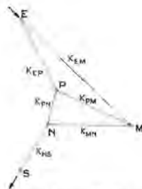
Fig. 5. — Schéma du réseau de ventilation, prêt pour le calcul.
