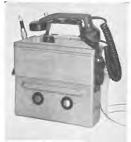
Fig. 22. — Poste radio-téléphone portatif à fréquence modulée, Siemens.
