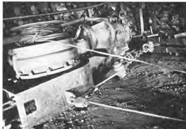
Fig. 10. — Tête motrice au cours du ripage; la tête motrice se trouve en tête de taille. On aperçoit le dispositif d'amarrage. Le câble passe sur une poulie de renvoi fixée à un étançon calé à front.
