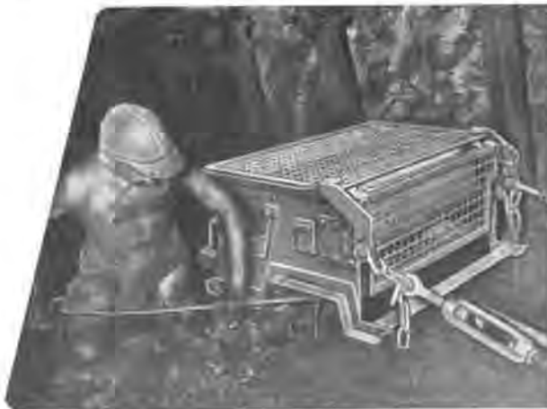
Fig. 13. — Station de retour de sécurité pour une courroie transporteuse.
