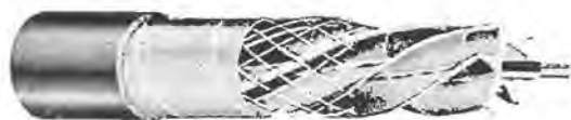
Fig. 19. — Coupe de câble de signalisation par contact montrant les détails de construction, Funke et Huster.
