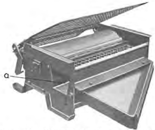
Fig. 14. — Vue du dispositif de raclage de la station de retour de sécurité.
