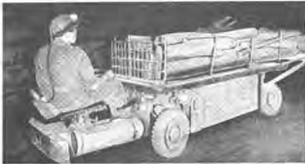
Fig. 12. — Transporteur Unicar sur pneus (Ruhrthaler).
