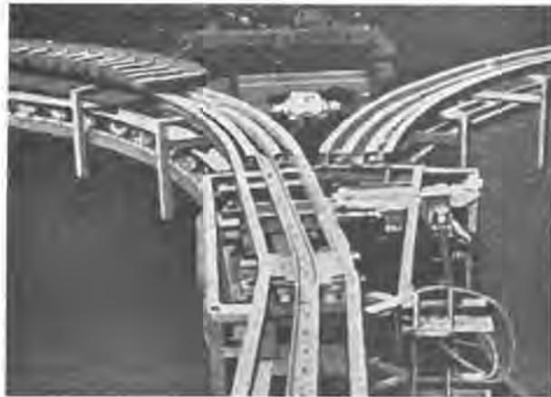
Fig. 13. — Aiguillage et interrupteurs magnétiques de commande des têtes motrices du convoyeur navette Hemscheidt.
