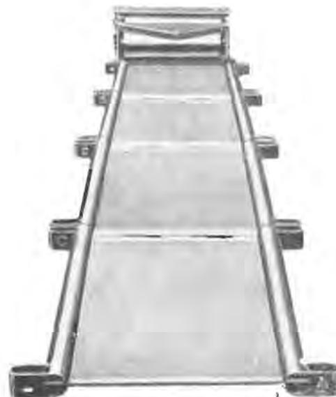
Fig. 1. — Courroie transporteuse sur tôle pour couche ultra-mince, voir être déplacés d'une allée à l'autre en les glissant sans les redresser.
