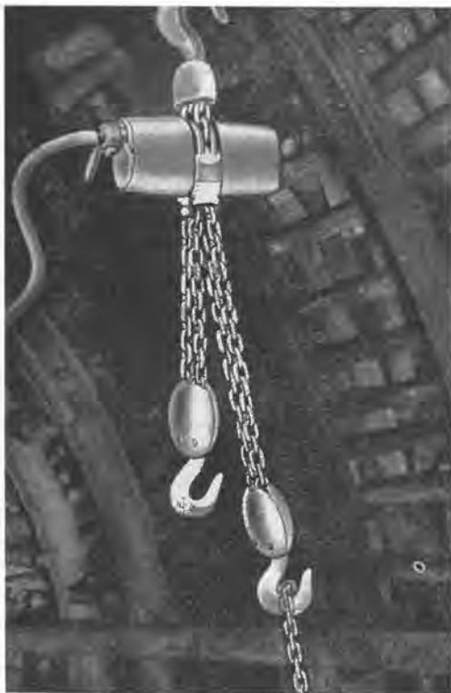
Fig. 20. — Palan à air comprimé (Neuhaus).
