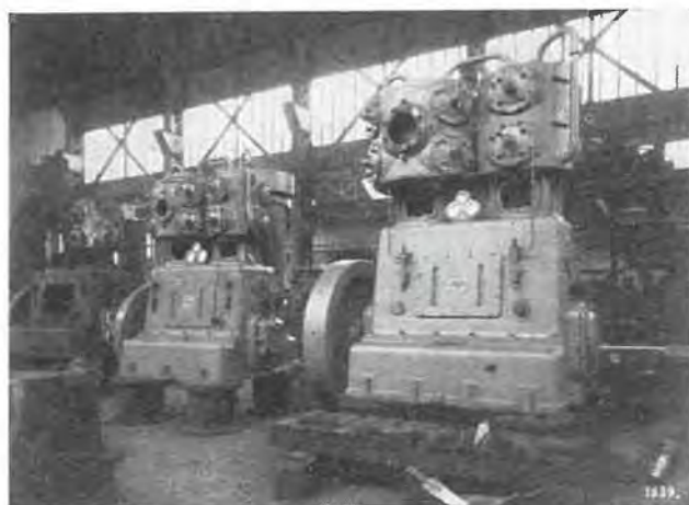
Compresseurs d'air 40 et 80 m 3 /min. - Pression 8 kg/cm 2 .
