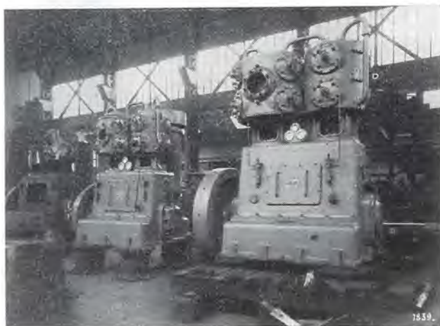
Compresseurs d'air 40 et 80 m 3 /min. - Pression 8 kg/cm 2 .
