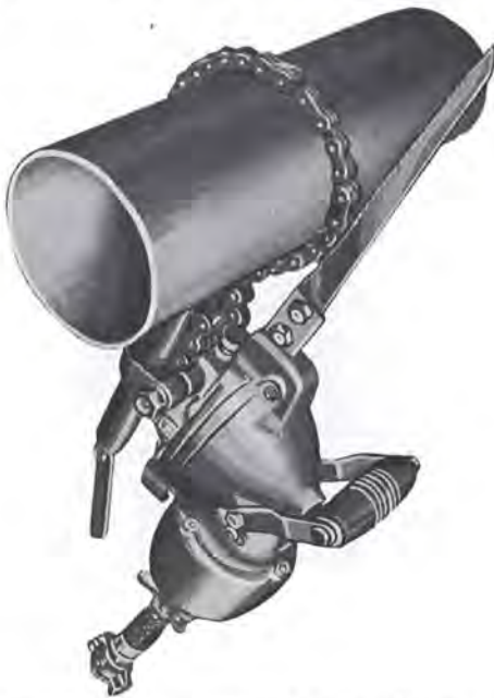
Fig. 54. — Scie à air comprimé Spitznas reliée par chaîne au tube à scier.
