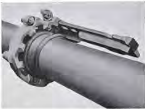
Fig. 12. — Accouplement tourneur du tube Réuss en service sur une tuyauterie.
