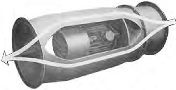
Fig. 25. — Ventilateur de poche Nüsse et Gräber. La flèche indique le trajet du courant d'air divisé en deux flux parallèles au droit de l'emplacement du moteur.
