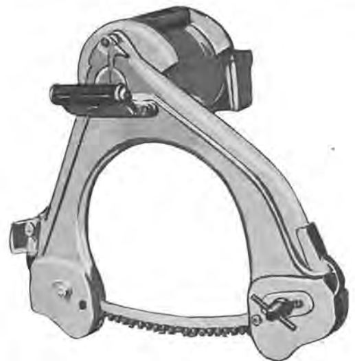
Fig. 53. — Scie à chaîne Stihl type E.B.L. La transmission du mouvement du moteur à la chaîne est directe.
