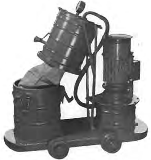
Fig. 24. — Capteur électrique de poussières Hemscheidt type E K E 5 a. La partie supérieure de la caisse à filtre se soulève pour permettre l'enlèvement du sac en papier.
