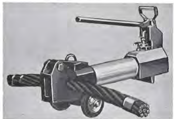
Fig. 56. — Sectionnement d'un câble à l'aide d'une cisaille hydraulique « Carricut ».
