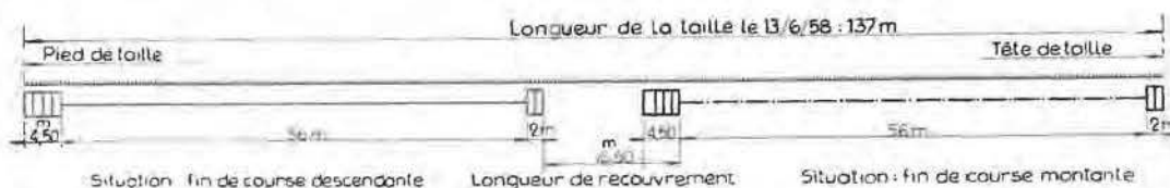
Fig. 11. Disposition des caisses de scraper en taille, en série, 1 caisse à 3 éléments et 2 flasques de 1,50 m et une caisse de 2 éléments.
