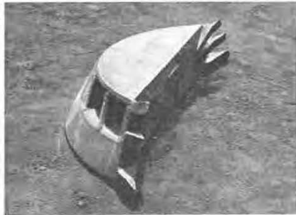
Fig. 4. — Bélier demi-lune, les couteaux sont soudés sur la face frontale.
