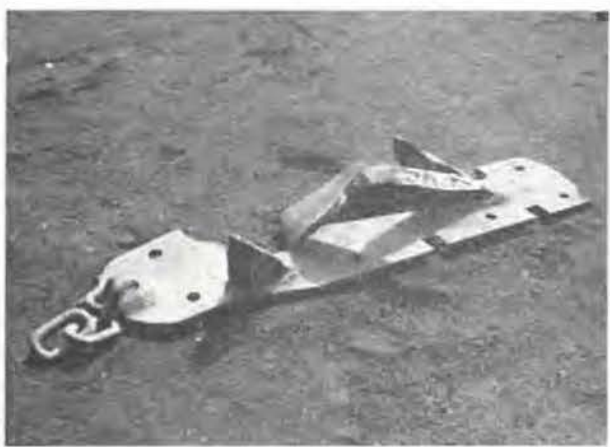
Fig. 15. — Couteaux de 0,22 m de hauteur soudés sur la plaque porte-couteaux; celle-ci s'est déchirée.
