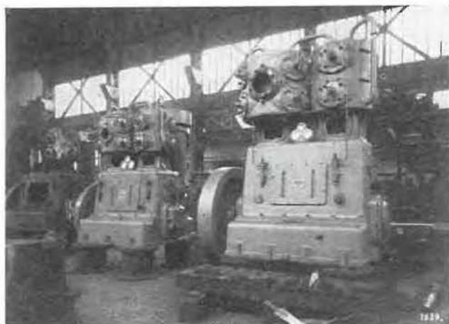
Compresseurs d'air 40 et 80 m<sup>3</sup>/min. - Pression 8 kg/cm<sup>2</sup>.
