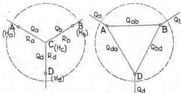
Fig. 3. — Transformation d'une étoile en un triangle équivalent en électricité.
