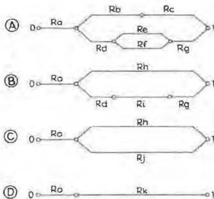
Fig. 2. — Réduction d'un réseau électrique simple.
