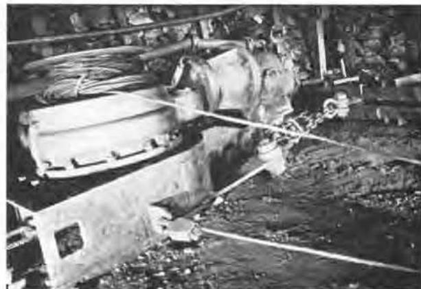
Fig. 10. — Tête motrice au cours du ripage: la tête motrice se trouve en tête de taille. On aperçoit le dispositif d'amarrage. Le câble passe sur une poulie de renvoi fixée à un étançon calé à front.
