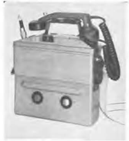
Fig. 22. — Poste radio-téléphone portatif à fréquence modulée, Siemens.
