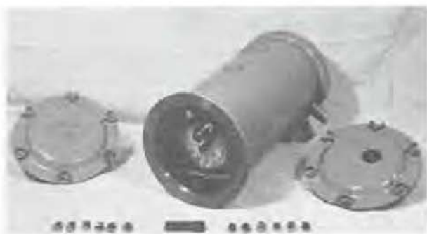
Fig. 33. — Camera dans un coffret anti-déflagrant avec ses couvercles.
