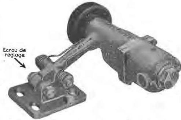
Fig. 10. — Vanne automatique de commande d'un pulvérisateur « autobeltspray ».
