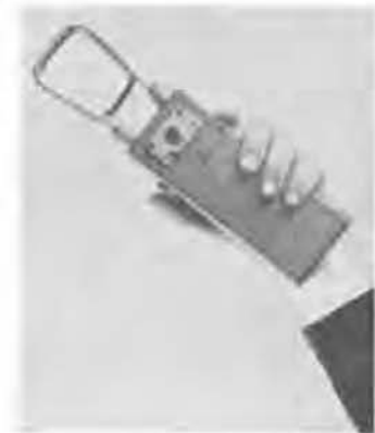
Fig. 24. — Poste radio-téléphone à fréquence modulée pour courte distance, Siemens.
