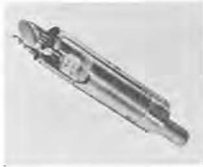
Fig. 31. — Caméra de télévision pour trous de sonde de 65 mm de diamètre Gründig.
