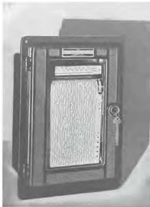
Fig. 16. — Appareil d'enregistrement des signaux de manœuvre et des mouvements des cages d'extraction.
