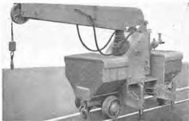
Fig. 8. — Grue hydraulique sur rail, force de levage 1.000 kg.
