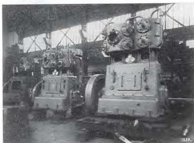
Compresseurs d'air 40 et 80 m 3 /min. - Pression 8 kg/cm 2 .
