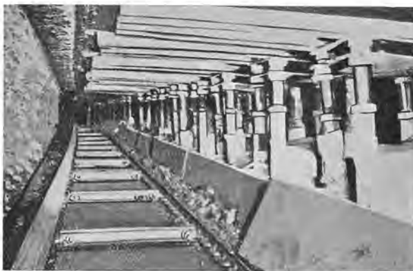
Fig. 7. — Vue de la taille équipée de piles marchantes du type « Seaman Gullick ».
