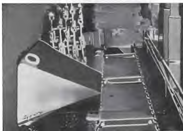
Fig. 2. — Anderton disc shearer avec charrieur de chargement. L'axe de rotation des disques n'est pas perpendiculaire au front de taille; dans le type actuel, il fait un angle de 7\frac{1}{2}^\circ alors qu'initialement cet angle était de 15^\circ .
