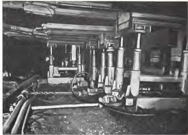
Fig. 4. — Soutènement marchant type « Seaman Gullick ».
