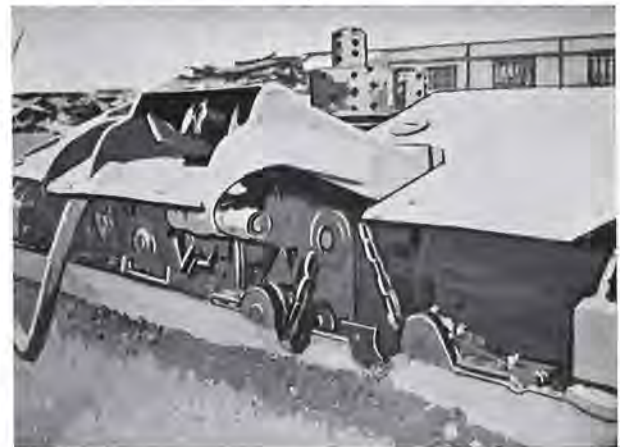
Fig. 5. — Le support des commandes a la forme d'un pont arqué qui enjambe le convoyeur et protège le câble électrique d'alimentation contre toute dégradation.
