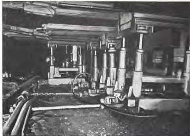
Fig. 4. — Soutènement marchant type « Seaman Gullick ».
