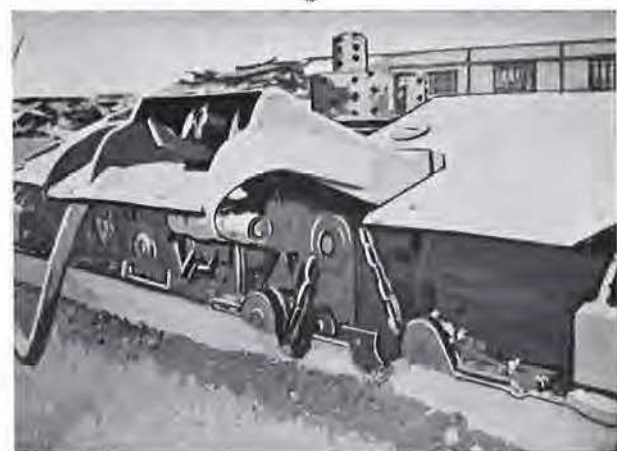
Fig. 5. — Le support des commandes a la forme d'un pont arqué qui enjambe le convoyeur et protège le câble électrique d'alimentation contre toute dégradation.
