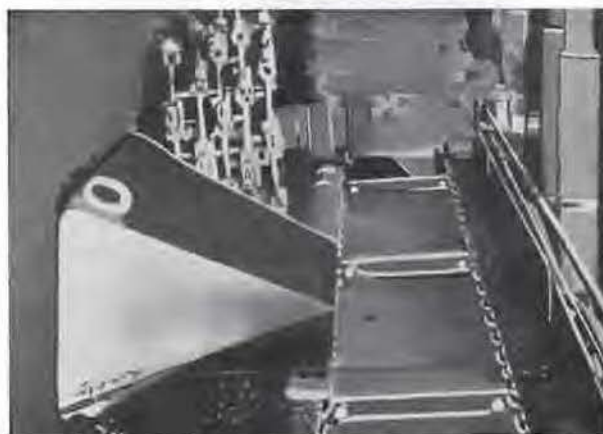
Fig. 2. — Anderton disc shearer avec charnu de chargement. Le charnu n'est pas perpendiculaire au front de taille; dans le type actuel, il fait un angle de 7\ 1/2^\circ alors qu'initialement cet angle était de 15^\circ .
