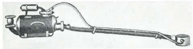
Fig. 25. — Ensemble : pompe, flexible d'aspiration, crépine avec flotteur.
