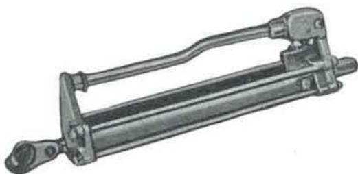
Fig. 1. — Tendeur hydraulique Brettell.
