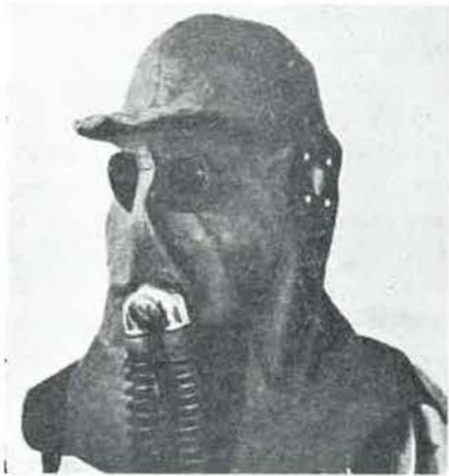
Fig. 37. — Capuchon ignifuge permettant de porter une casquette et un appareil respiratoire.
