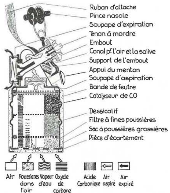
Fig. 41. — Coupe au travers d'un masque auto-sauveteur.
