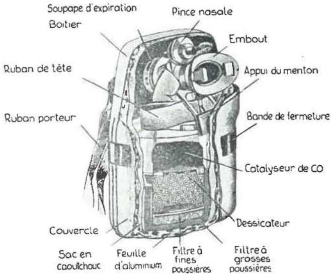
Fig. 42. — Appareil auto-sauveteur Dräger modèle 623.
