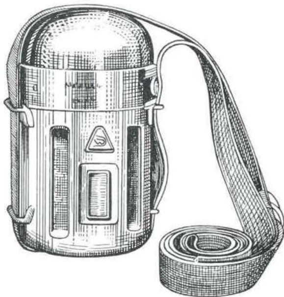
Fig. 43. — Appareil auto-sauveteur Dräger modèle FSR 750.
