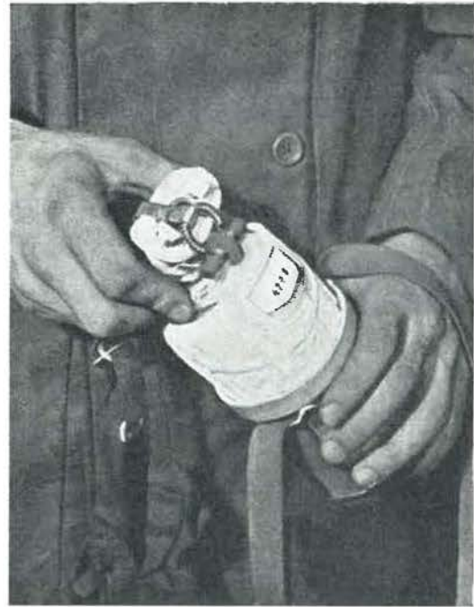
Fig. 43bis. — Appareil Dräger modèle FSR 750 retiré de sa gaine protectrice.
