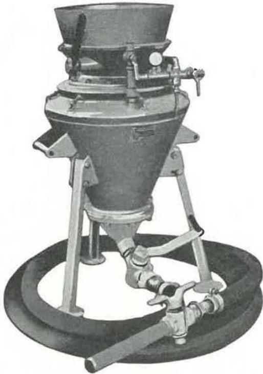
Fig. 36. — La cuve à pression Rheinelbe.
