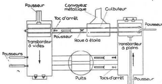
Fig. 10. — Circuit des berlines en surface.
