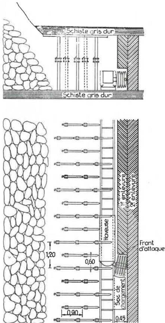
Fig. 4. — Schéma de l'architecture du soutènement et des enlèvements prises en un poste par la machine.
