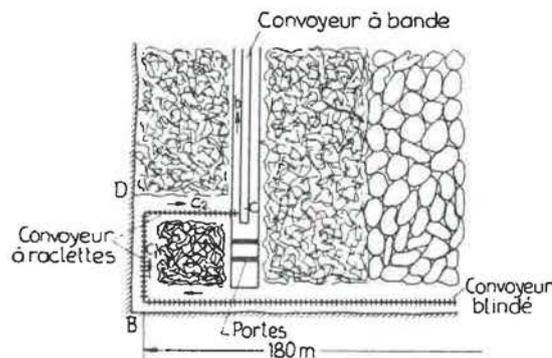
Fig. 8. — Détail du bosseyement en arrière des fronts.
