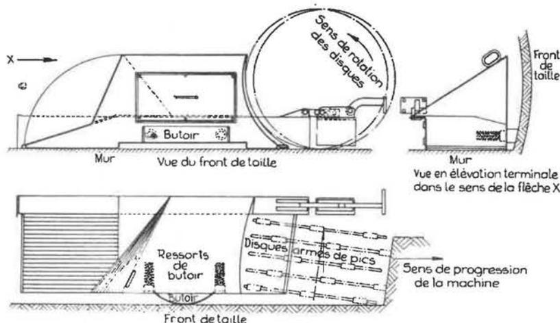
Fig. 3. — Détail de la charrieuse et du mode d'attaque de la veine par les disques armés de pics.
