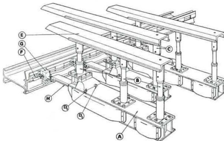
Fig. 5. — Représentation schématique du soutènement marchant Dowty.
