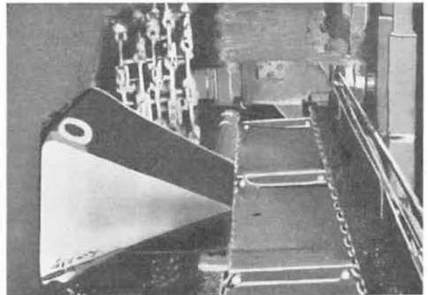
Fig. 2. — Anderton disc shearer avec charrieuse de chargement. L'axe de rotation n'est pas perpendiculaire au front de taille; dans le type actuel, il fait un angle de  $7\frac{1}{2}^\circ$  alors qu'initialement cet angle était de  $15^\circ$ .
