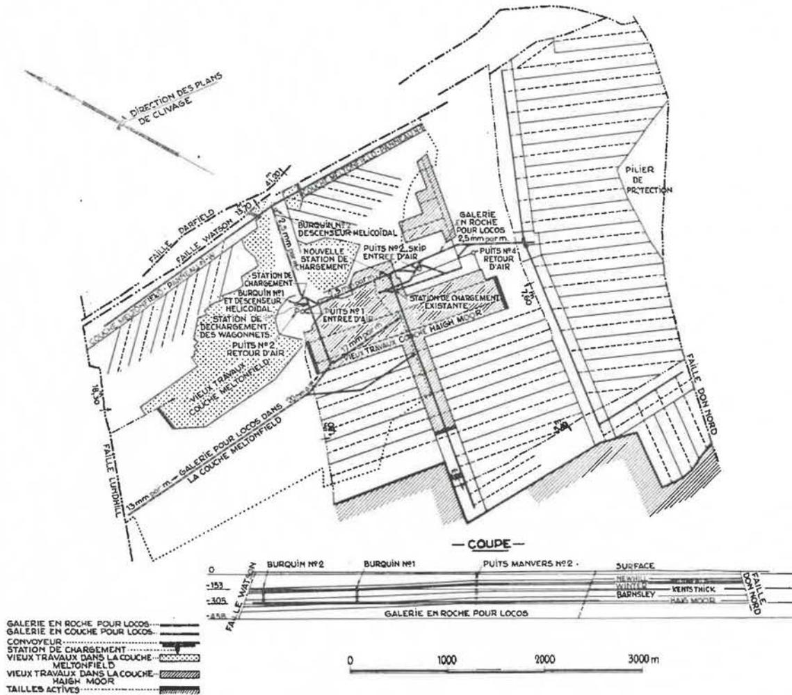
Fig. 4. — Planning d'exploitation des couches Meltonfield et Haigh Moor aux mines Wath et Manvers.
