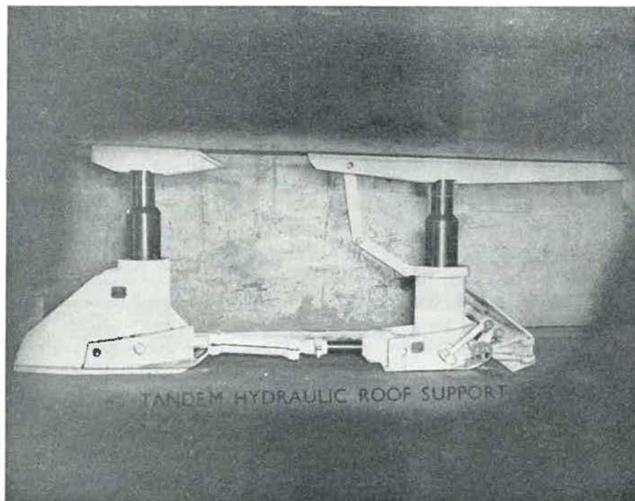
Fig. 5. — Soutènement marchant Bolton pour couches d'ouverture moyenne.
