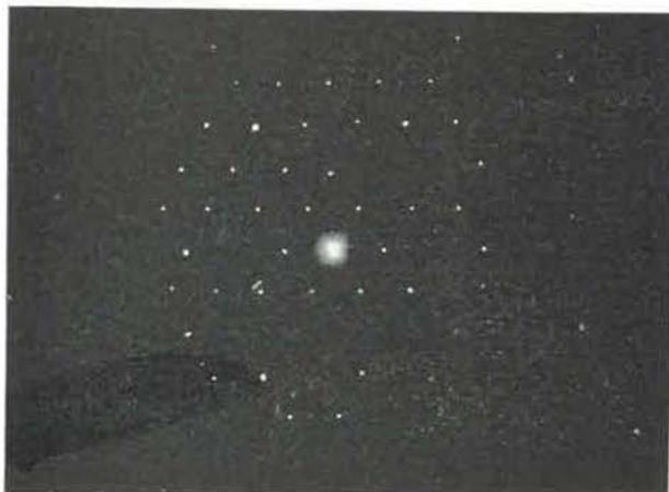
Fig. 12. — Diagramme de diffraction électronique de la houille.
