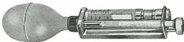
Fig. 16. — Détecteur colorimétrique MSA pour l'analyse du CO.
