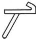
Fig. 39. — Attache de rail aux traverses Pettep-Zapfen.
