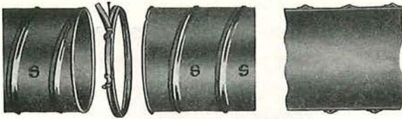
Fig. 7. — Canar en plastique Schauenburg pour aérage aspirant et soufflant.
