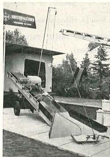
Fig. 82. — Le scraper à main Ettliger.
