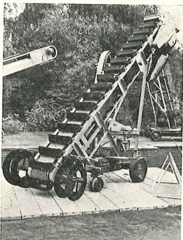
Fig. 83. — Chaîne à godets pour reprise au tas de la firme IMA.
