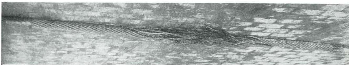
Fig. 2. — Rupture d'un câble rond en pleine éprouvette (amarrage par coins différentiels).
