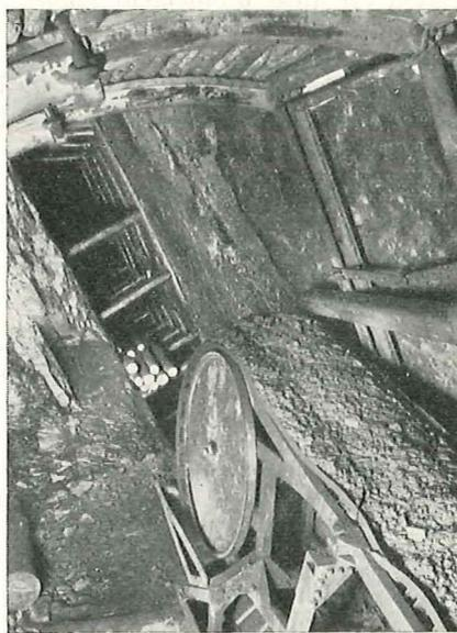
Fig. 116. — Déversement en tête de taille des remblais apportés par le train-navette à bande de Hemscheidt.
