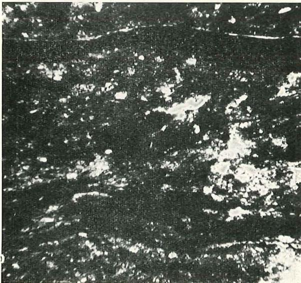
Fig. 25. — Houthalen 37/19. Schiste très carbonneux - x 70 Lumière parallèle.
