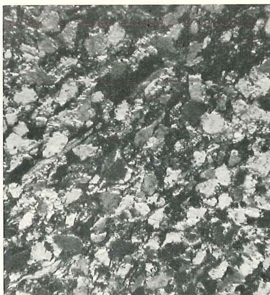
Fig. 23. — Monceau-Fontaine - Follemprie - 20 cm sous la veine. Quartzite micacé gris-stratification apparente x 70 - Nicols croisés.
