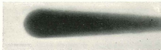
Fig. 14. — Décomposition explosive de peroxydes dans le mélange : 2 F + 1 O_2 à 486° C et 13,5 cm Hg.
