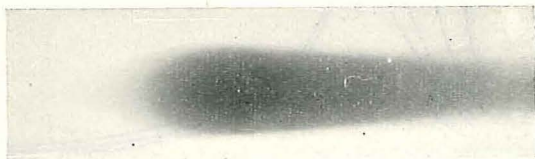
Fig. 10. — Inflammation thermique du mélange 1 F + 4 O 2 . Photographie de la flamme sur film mobile. Translation du film : 41 m/sec (droite vers la gauche). Récipient sphérique Ø 4,8 cm. Température 485° C. Pression : 31,68 cm Hg.
