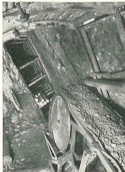
Fig. 116. — Déversement en tête de taille des remblais apportés par le train-navette à bande de Hemscheidt.
