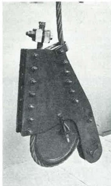
Fig. 7. — Attache de câble du type auto-serrage.
