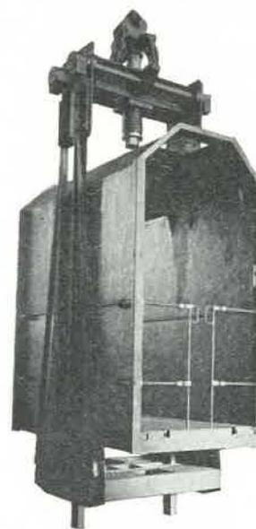
Fig. 4. — Guides dans le cadre de suspension de la cage, mine de Bodas.
