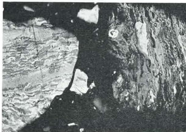
Fig. 4. — Comparaison entre un charbon à gaz et un charbon gras : à gauche : charbon gras ; à droite : charbon à gaz.
