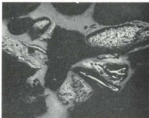
Fig. 9. — Pâte à coke chauffée à 410° C (vitesse de boursoufflement très élevée).
