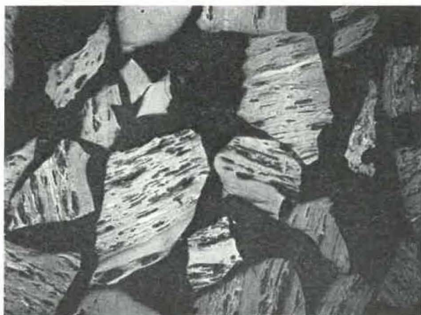
Fig. 7. — Pâte à coke à la température ordinaire — grains de 0,210 à 0,246 mm.
