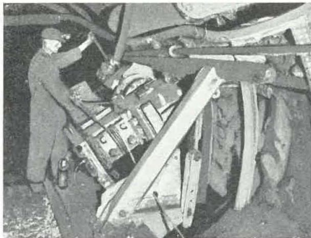
Fig. 16. — Rabot en fort pendage couche Geitling à « Alter Hellweg ».
