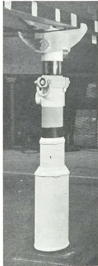
Fig. 19. — Etançon hydraulique avec tête articulée supportant deux rallonges.
