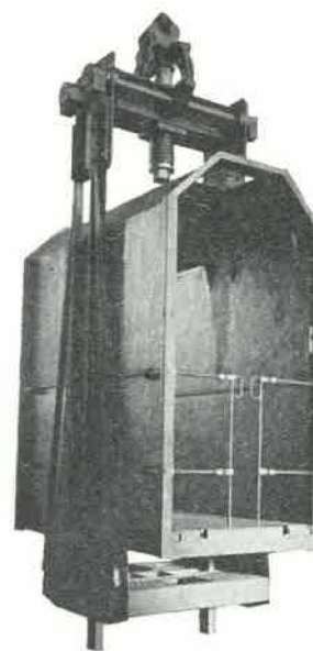
Fig. 4. — Guides dans le cadre de suspension de la cage, mine de Bodas.
