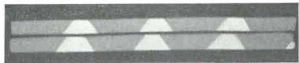
Fig. 35. — Tuyau Zebra de la firme Beien durci par induction.
