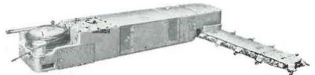
Fig. 20. — Haveuse Eickhoff SE III avec bras en position de havage.
